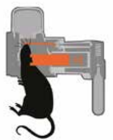
2. CO2-patronen skyder et stempel ned i hovedet på rotten
